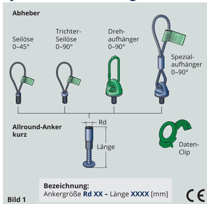
Die Allround-Anker kurz sind Teil des Gewindeankersystems und werden flächig in plattenartige Betonbauteile oder im Treppenauftritt von Fertigteiltreppen eingebaut. Das Gewindeankersystem besteht aus Transportankern, Abhebern, farb-codierten Datenclips und einem umfangreichen Sortiment an Zubehörteilen. Das System wird zum Heben, Transportieren und Versetzen von Fertigteilen verwendet. Diese Broschüre beschreibt alle relevanten, technischen Informationen zur Verwendung der Allround-Anker kurz.
