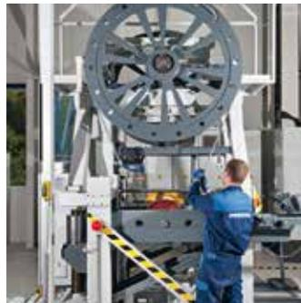
Prüfstände zur Ermittlung der Biegewechselfestigkeit
