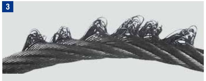
Durch Abrostung und Abrieb stark gelockerte Litze
