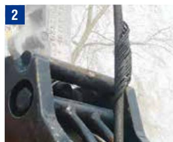
Durch Zuziehen einer Seilschlinge entstandene Klanke
