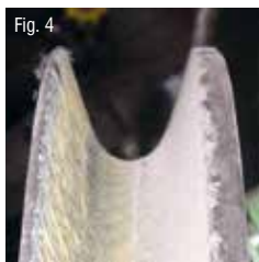
Fig. 4 Exemple : usure unilatérale au niveau du flanc de la gorge
