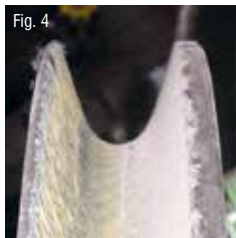
Fig. 4 Esempio: Usura unilaterale sul fianco della gola
