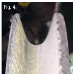
Ejemplo: desgaste unilateral en un flanco de la garganta
