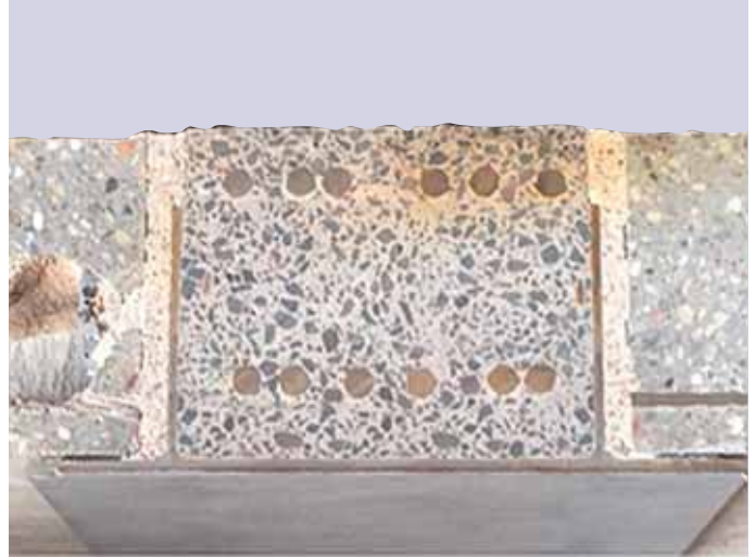
Bild 3: Sägeschnitt durch den Hybridbeam mit Füllbeton und Bewehrungskorb mit seitlich aufgelegten Hohlblechenelementen und vergossenen Zwischenräumen
