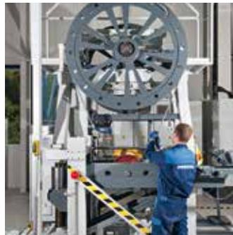
Prüfstände zur Ermittlung der Biegewechselfestigkeit
