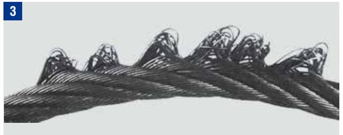
Durch Abrostung und Abrieb stark gelockerte Litze
