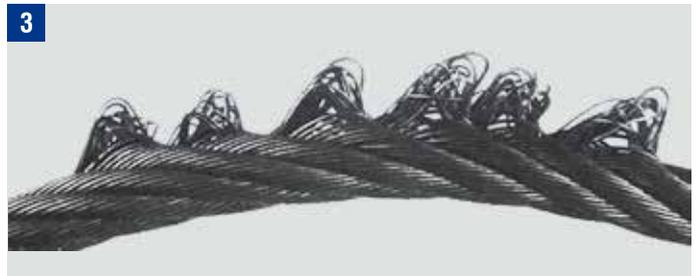
Durch Abrostung und Abrieb stark gelockerte Litze
