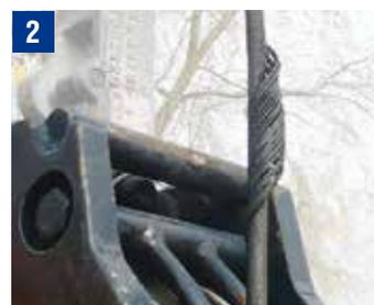
Durch Zuziehen einer Seilschlinge entstandene Klanke
