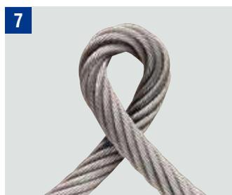
Durch mechanische Einwirkung entstandener Knick
