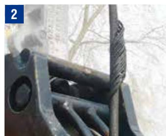
Durch Zuziehen einer Seilschlinge entstandene Klanke
