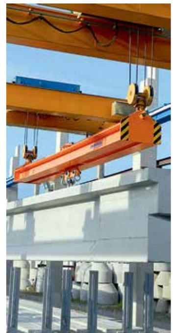
**Zwei Zweikrantraversen für den Transport von 46t schweren Betonsegmenten mit einer Länge von 35m.**
