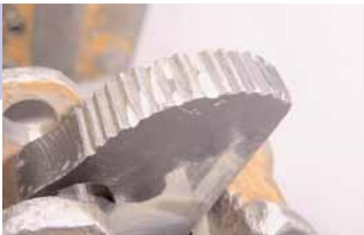
Foto Nr. 3 zeigt verschlissene und ausgebrochene Zähne.
