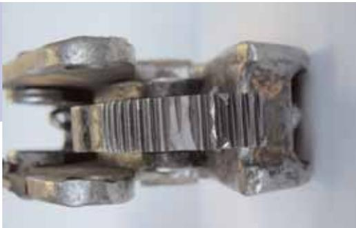
Foto Nr. 2 zeigt verschlissene Zähne und auch zwei komplett ausgebrochene Zähne.
