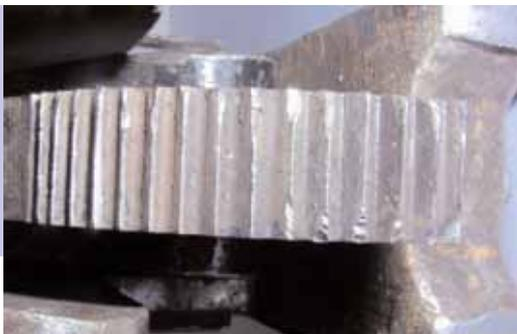
Foto Nr. 3 zeigt verschlissene und zerdrückte Zahnkanten. Dies rührt vom Einsatz an extrem harten Blechen (größer als 300 HB).
