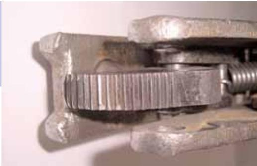
Foto Nr. 2 zeigt verschlissene Zähne und ausgebrochene Kanten.
