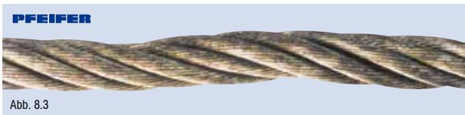
Abb. 8.3 Lokale Verringerung des Seildurchmessers (eingesunkene Litze)
