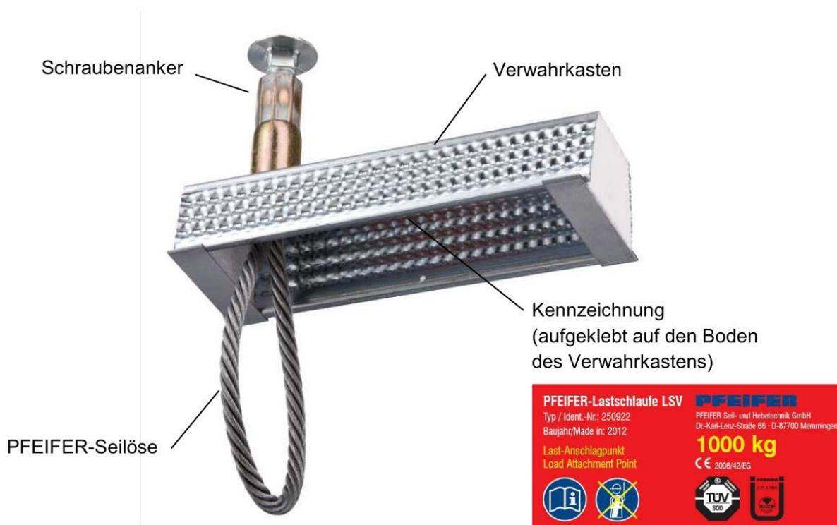
Abbildung 1: Bestandteile der PFEIFER-Lastschleife LSV – Bild aus Betriebsanleitung
