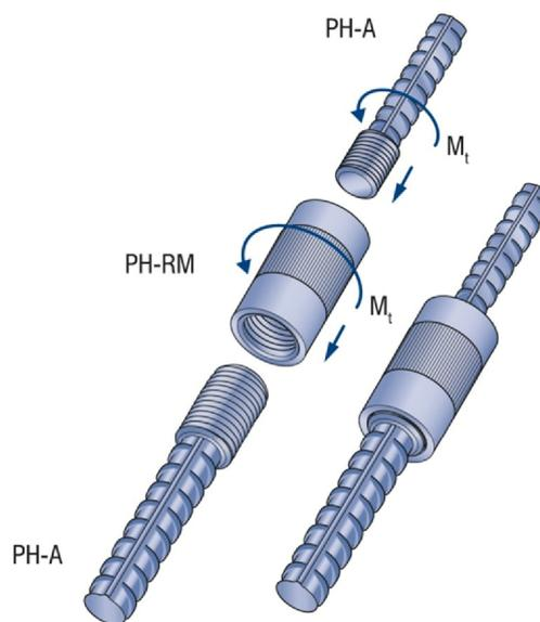
1) Wahlweise kann einer der beiden Anschlussstäbe durch einen Muffenstab PH-MU mit Koppelbolzen ersetzt werden
