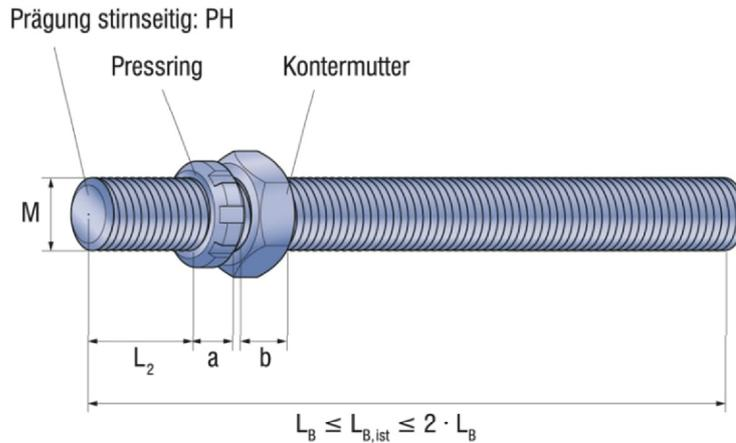
**Tabelle 31: Bolzenabmessungen PFEIFER-Positionieranschluss PH-PA**
