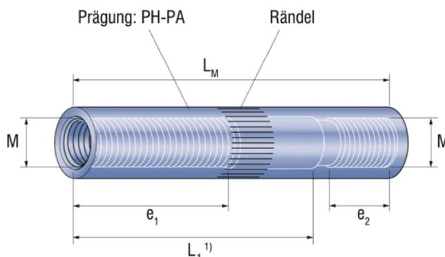
**Tabelle 29: Hülsenabmessungen PFEIFER-Positionieranschluss PH-PA**
