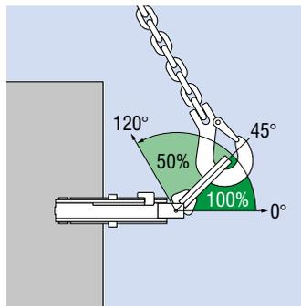
Anwendung: Seitliches Anschlagen im 2-Strang-Kettengehänge
