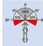
Im Vergleich: Wettbewerberprodukt mit 50 % Tragfähigkeit bis zu einem Winkel von 90°
