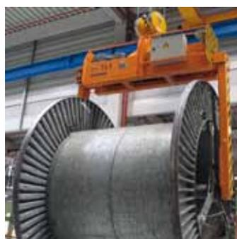
Greifer für Kabeltrommeln 14t, Greifbereich 950–2120 mm
