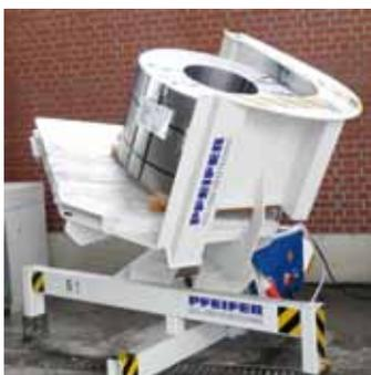
Dreh-Wendetisch 6t für Coils bis Durchmesser 1700 mm und einer Coilbreite von 800 mm
