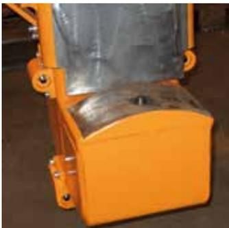
Mit **eingebauter Lastsicherung** zur Sicherung gegen unbeabsichtigtes Öffnen unter Last – angezeigt über Signallampen auf dem Führungsgehäuse.
