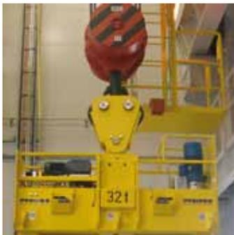
**Aufhängung** für Doppel-Kranhaken nach DIN 15402 oder direkte Einscherung bei Automatikbetrieb
