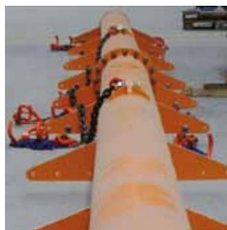
Auch als **verwindungssteife Rohrprofilkonstruktion** bei extrem langen Lasten
