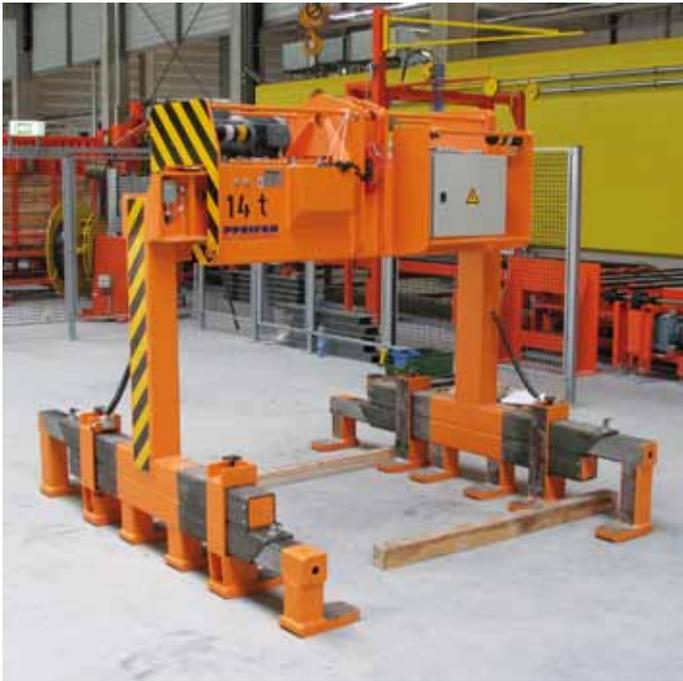
Robuste Bauweise mit einem geschweißten Führungsgehäuse, zwei verstellbaren Zangenarmen sowie manuell teleskopierbaren Auflagepratzen
