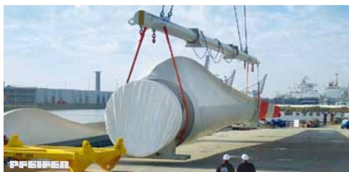
**Rohrtraverse** zum Transport von Rotorblättern für Windkraftanlagen
