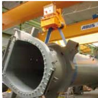
Einzelne Wendeeinheit: Stromversorgung über Akkus
