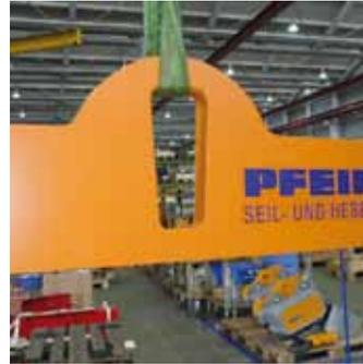
**Mit Aufhängeöse** für Einfachkranhaken nach DIN 15401
