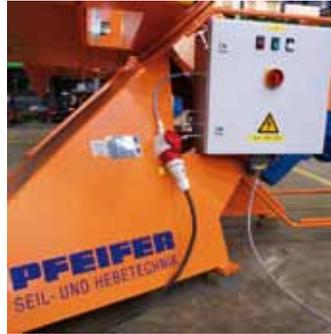
Das Gerät wird **komplett betriebsbereit** mit einem Anschlußkabel geliefert, 400 V – 50 Hz.
