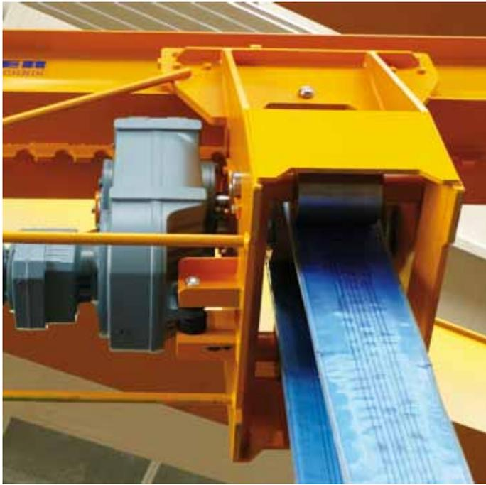
Mit **PU-beschichteten Hebebändern**, die ein Rutschen des Bandes vermindern. Zusätzlicher Schutz gegen Rutschen durch Vergrößerung des Umschlingungswinkels aufgrund **Umlenkrollen**.
