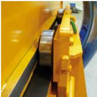
**Rollengelagerte Wendeeinheiten** für leichtes Verschieben
