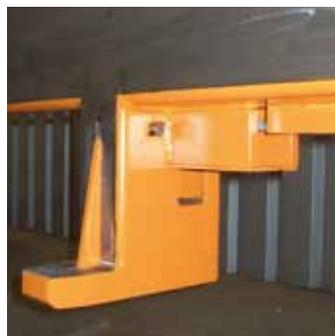
Beim Anfahren der Arme an das Paket schalten **Abschaltklappen oder Lichttaster** die Zangenarmschließbewegung ab.
