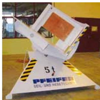
Dreh-Wendetisch 5t mit Schonbelag für Coils bis Durchmesser 1800 mm (auf Paletten)
