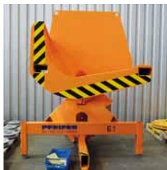
Dreh-Wendetisch 6t für Coils bis Durchmesser 1200 mm und einer Coilbreite von 700 mm
