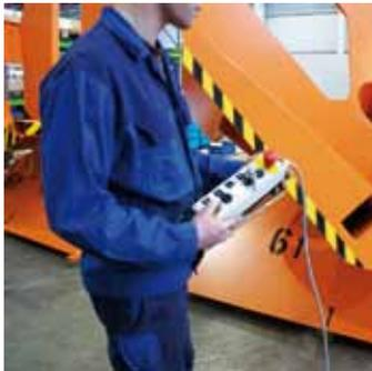
Die Bedienung (Wenden vor, Wenden zurück, Not-Stop) erfolgt mit einer **Funkfernsteuerung**. Damit die Last schonend gewendet wird, ist der Wendetisch mit einem **Frequenzumrichter** zum sanften Anlauf und Stop ausgestattet.
