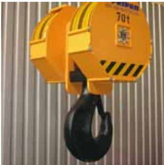
Eine **Drehwinkelbegrenzung** ist sinnvoll, wenn bestimmte Positionen des Hakens beim Aufnehmen oder Absetzen der Last erreicht werden müssen. Sie ist zwingend erforderlich, wenn ein Lastaufnahmemittel mit elektrischer Zuleitung eingehängt ist.
