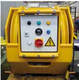
**Kranunterflasche mit Akkubetrieb:** Die zwei Akkublöcke sind leicht austauschbar; mit digitaler Spannungs- bzw. Restlaufzeitanzeige ca. 1000 Ladezyklen/Ladezyklus.
