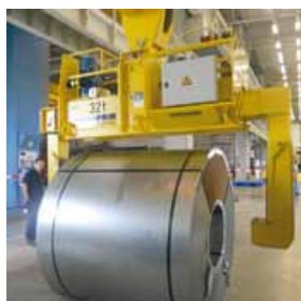
Coilzange 32t mit Drehwerk und Doppelhaken-Aufhängung
