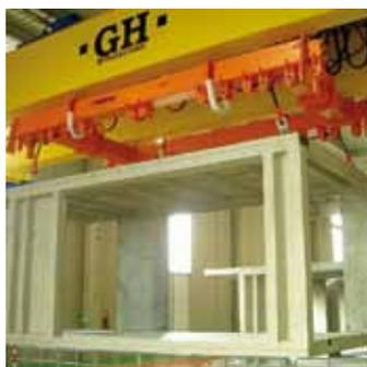
Rahmentraverse für quaderförmige Betonfertigteile mit Ausgleichskette
