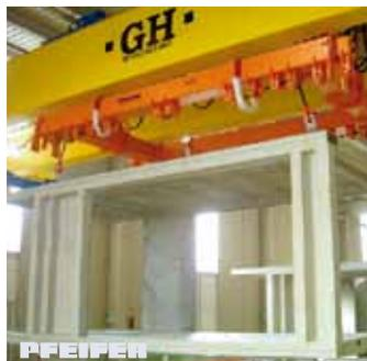
**Verstellbare Traverse** für Lasten bis 180t mit eingebauten Lasthaken
