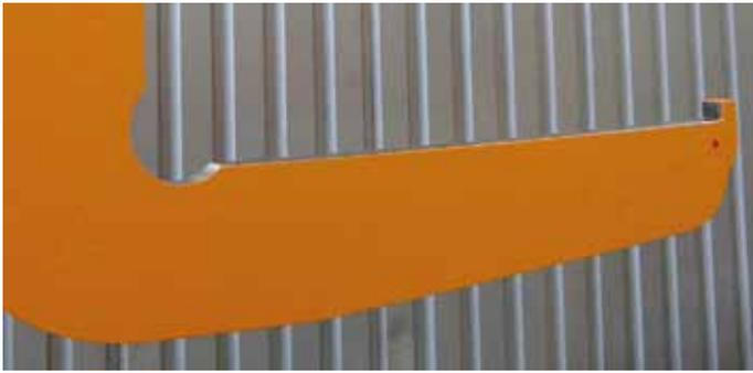
**Mit 4/4-Zinke**, d. h. der Coil liegt mit der gesamten Breite auf der Zinke auf. Bei Belastung im Lastschwerpunkt (Mitte 4/4-Tragarm), richtet sich die Coilzinke in eine Sicherheitsneigung von ca. 3–5° nach oben aus.
