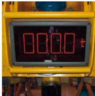
Genaueres Wiegen bei kompakter Baugröße: Die **Wiegeeinrichtung** leistet Präzisionsarbeit. Eine digitale Lastanzeige kann an der Unterflasche angebracht werden.
