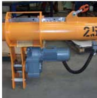
**Ausführung als Rohrtraverse** zur Erhöhung der Verwindungsfestigkeit
