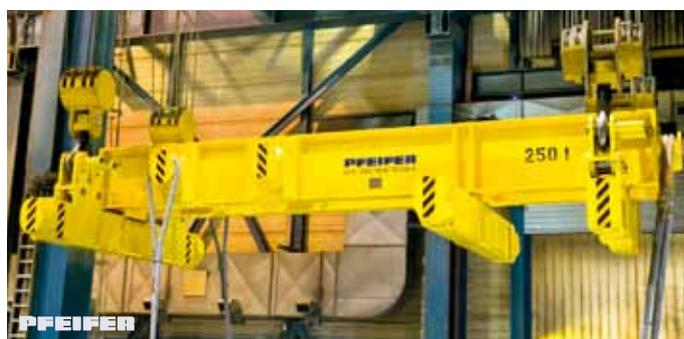
**Traverse zum Transport von Wasserturbinen** mit 250t Gewicht
