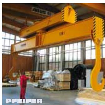
**Langhaken-Traverse** ausgerüstet mit Drehwerk zum Heben und Positionieren von Lasten bis 138t
