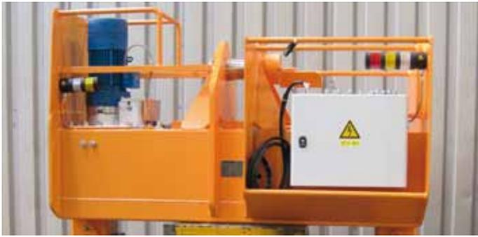
Stabiles, verwendungssteifes **Stahlgehäuse in Kastenbauweise**. Die Tragarme werden über einen umlaufenden, hochfesten Rollenkettenantrieb in Gehäuse-Längsrichtung auf Gleitleisten bewegt.
