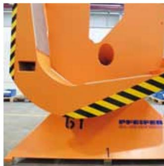
Aufnahmemöglichkeit zum Transport des unbeladenen Wendetisches mittels Gabelstapler
