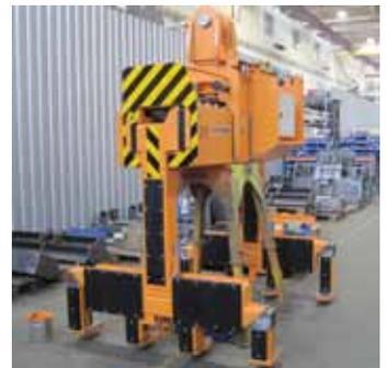
Ausführung mit Drehwerk, Laserpointern zur Zangenpositionierung und Prallschutz
