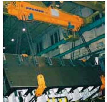
Schwerlastausführung mit Ketten zum Wenden extrem schwerer Bauteile
