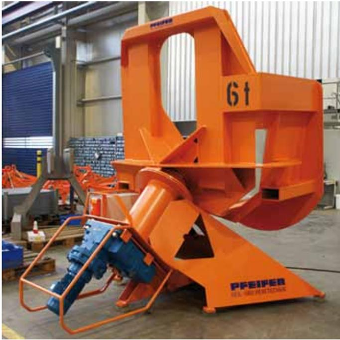
Der PFEIFER-Wendetisch besteht aus einem Grundgestell mit einer Drehachse. An dieser Drehachse ist der Auflagetisch befestigt. Wenn nun die Drehachse um 180° gedreht wird, dreht sich die Last um 90°. Dabei verläuft die Mittellinie der Drehachse durch den Schwerpunkt der Last. Dadurch kann auf aufwendige Sicherheitstechnik verzichtet werden.
