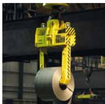
Coilzange 48t, Steckbolzenaufhängung mit Rollenführung und beweglichen Coilauflagen
