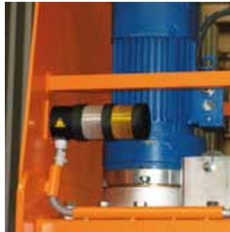
**LED-Signallampen** auf dem Führungsgehäuse zeigen dem Bediener den Betriebszustand an.
