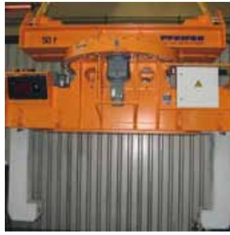
**Elektromotorischer Zangenantrieb** mit Stirnradtriebemotor und hoch fester Trapezgewindespindel
