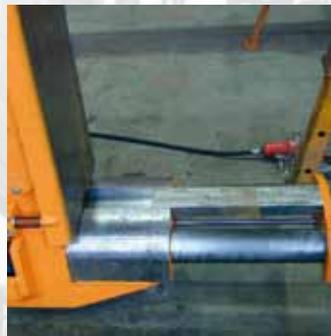
**Ausfahrbare Prätzen** zur Erweiterung der Zangengreifweite auf zusätzliche kleine Lastabmessungen, wie beispielsweise Spaltcoils
