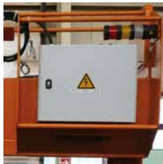
**Komplett verdrahtet**, mit elektrischer Steuerung im Schaltkasten und mit Steckverbindung zum Anschluss an die Kranelektrik
