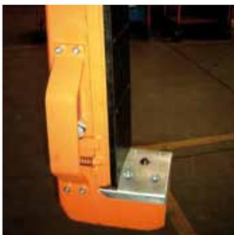
**Prallschutz an den Zangenarm-Innenseiten.** Zur Reduzierung von Coilbeschädigungen wird an den Arm-Innenseiten bzw. an den Abschaltleisten ein Prallschutz aus Polyurethan (vergleichbar Secutex oder Vulkollan) schraubbar angebracht.
