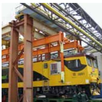
Systemtraverse für Mehrkran-Betrieb
