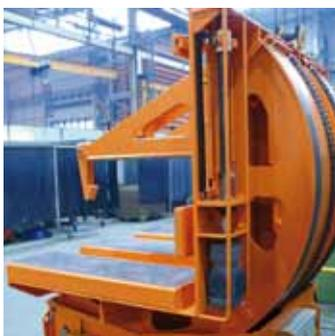
Aufsatz zum Separieren von Blechstapeln zur Einzelprüfung von Blechen
