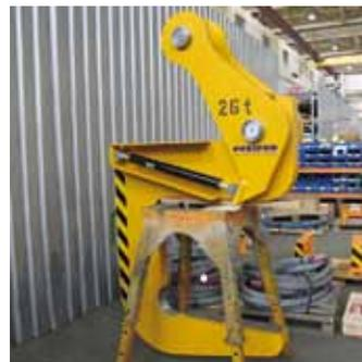
**Automatischer Ausgleich** zwischen Leer- und Lastzustand bei max. Lastschwerpunkt
