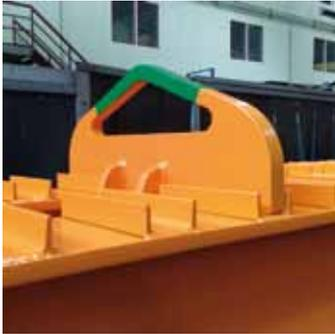
Einstellen der benötigten Arbeitslänge durch **manuelles Umhängen der Verstellbügel** mit Hilfe der Handgriffe
