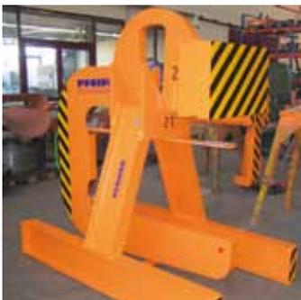
**Ablagegestell** für kippsicheres Lagern. Nach BGR 500 müssen C-Haken und Anschlagmittel so abgestellt oder abgelegt werden, dass sie nicht umkippen, herabfallen oder abgleiten können.
