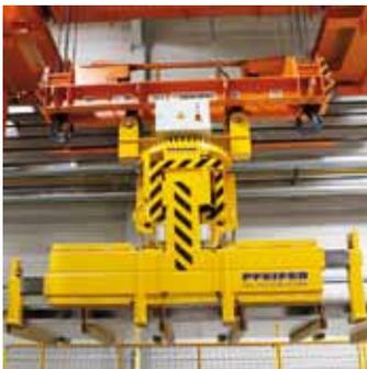
Mit Horizontaldrehwerk und elektromotorisch verfahrenbaren Auflagepratzen
