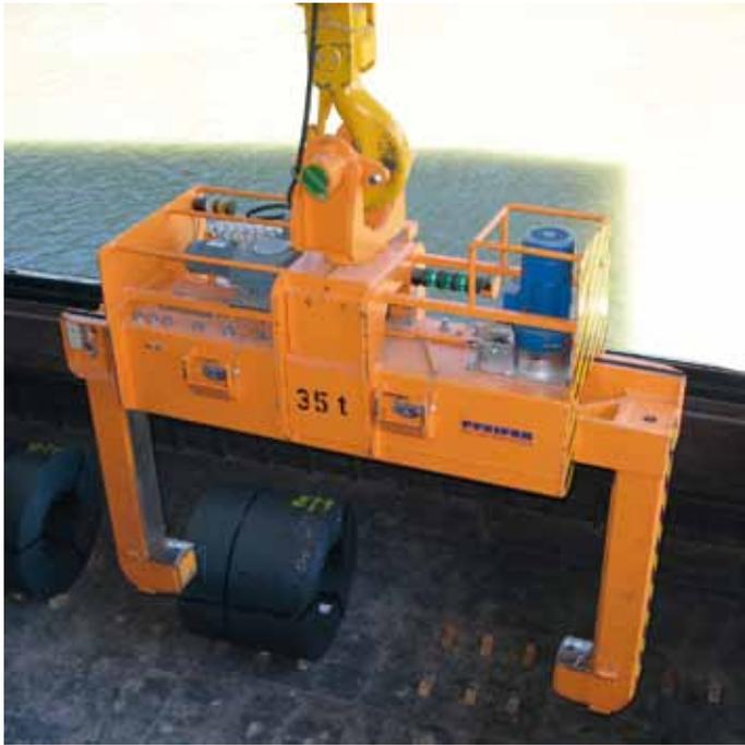
**Integriertes Zangendrehwerk** zum genauen Positionieren der Last mit Drehbereichsbegrenzung oder Endlosdrehwerk. Auf Wunsch mit Positionsendschalter zur Abschaltung der Drehbewegung vor mechanischem Anschlag
