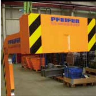
**Mit Gegengewicht** für eine waagerechte Zinkenlage im Leerzustand
