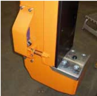
Mit **Abschaltklappen** zum sicheren Abschalten der Zangenarm-Schließbewegung – angezeigt über Signallampen auf dem Führungsgehäuse bei richtigem Anliegen an der Last.
