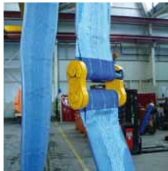
**Spezialschlösser:** Leicht zu öffnen und durch die Antriebsrollen der Wendetraverse fahrbar
