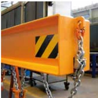
Mit **Kettenverkürzer**, der das Anpassen der Kette ermöglicht, wenn nicht alle Haken an die Last angeschlagen werden. Der Verkürzer ist stirnseitig an der Traverse angebracht.
