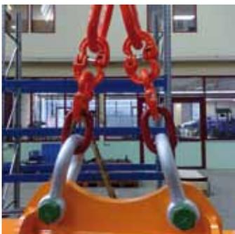
Traversenaufhängung für **Doppelhaken** nach DIN 15402
