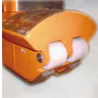
**Stirnseitige Rollen in den Coilauf-lagen integriert.** Polyurethan-Schutzrollen an den Innenseiten der Zangenarme, damit beim Absenken der Coilzange die empfindlichen Schnittkanten nicht beschädigt werden.
