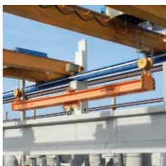
Traverse für Betonfertigteile
