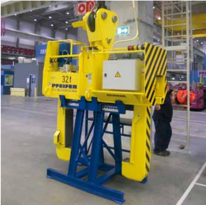
**Abstellbock** mit Leiter und Wartungspodest. Ausführung in stabiler Blech-konstruktion mit Aufstieg, Gitterrost-Podest und mit Befestigungsmöglichkeiten am Hallenboden.
