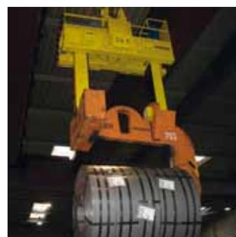
Coilzange 34t mit Drehwerk, Lichttastern, Bohrungssuche und Schonbelag auf den Zangenarm-Innenseiten
