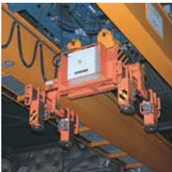
**Drehbare Pratzen** zur Verkleinerung des Platzbedarfes zwischen den Blechpaketen
