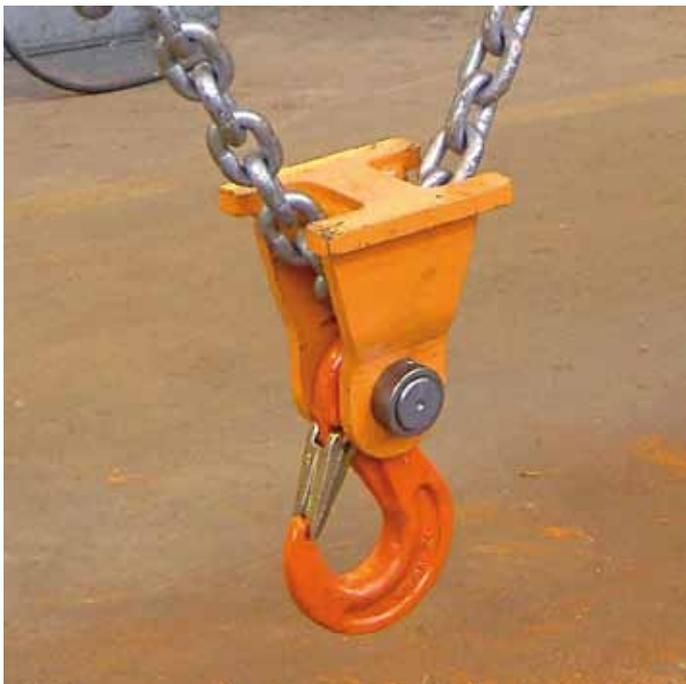
Lastaufnahme durch **Ösen-Lasthaken** (nicht drehbar)
