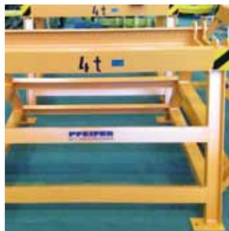
**Ablagegestell** oder alternativ an der Traverse **angeschweißte bzw. angeschraubte Absetzfüße**
