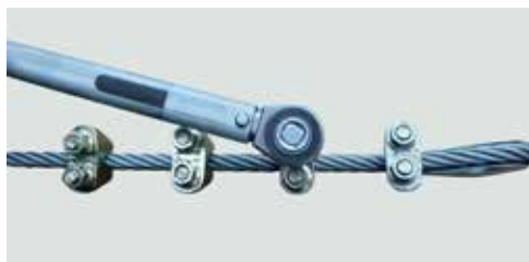
Abb. 12: Anziehen der Schrauben mittels Drehmomentschlüssel
