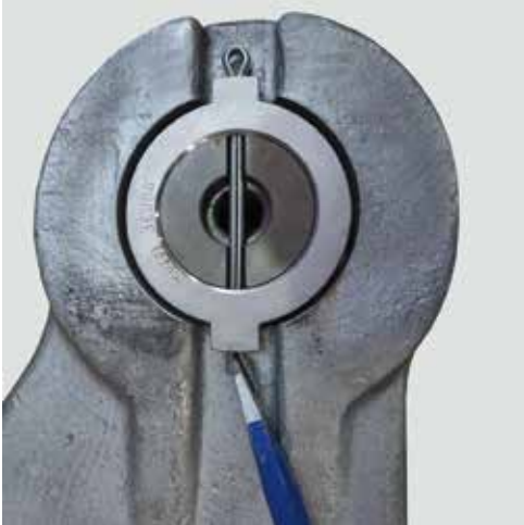
Rys. 8.2.4.4: Włożenie i zabezpieczenie zawlecзки
