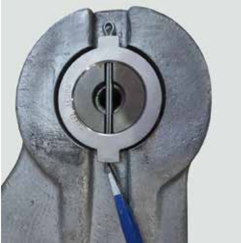
Abb. 8.2.4.4: Einstecken und Fixieren des Sicherungssplintes
