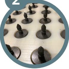
Bestücken des Tablettts mit den gereinigten, geölten Magneten für leichteres Handling im Folgeprozess
