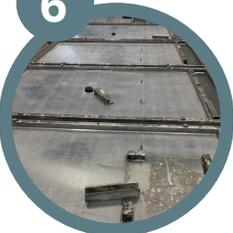
Rückführung der Magnete zur Reinigung sowie wiederholten Prozessablauf.
