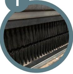
Automatisches oder manuelles Reinigen und Einölen der Magnete für eine längere Lebensdauer der Werkzeuge.
