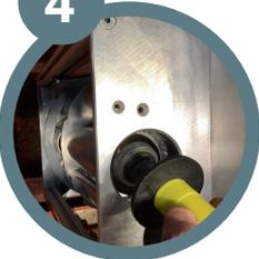
Befüllung des Setzgeräts zur Produktion und Rückzählung des Verbrauchs mit akustischem und/oder optischem Hinweis zur Auffüllung.
