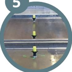
Satz der Magnete inkl. MoFi sowie Produktion der Betonfertigteile
